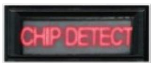
图 3-19 碎屑探测器告警灯
